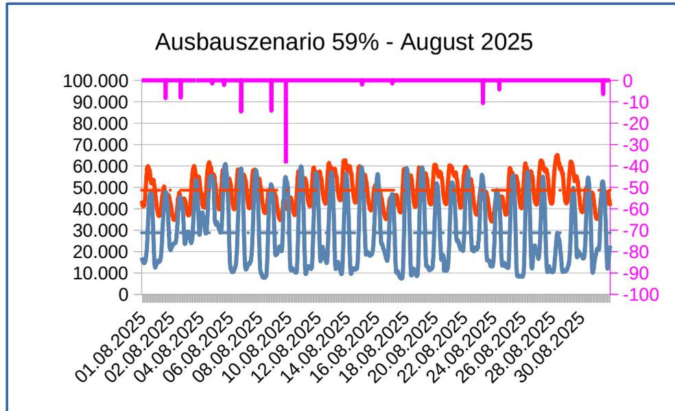
**Diagramm 1:** Verläufe von Ökostromerzeugung (Wind, PV, Biomasse und Wasserkraft) und Stromverbrauch bei aktuellem Ausbaustatus Juli 2025
