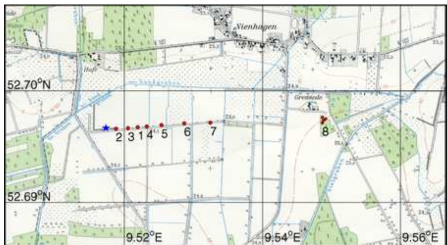
Infraschallmessung an 200 kW Windkraftanlage vom Typ Vestas V47 nördlich von Hannover. Die Registrierung mit MB2000 Mikrobarometern erfolgte entlang eines etwa 2 km langen Profils Quelle: BGR
